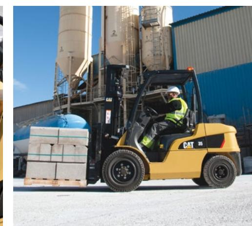
Geniş bir özellikler dizisi Cat forkliftinizin teknik özelliklerini uygulamanıza eşleştirmenizi sağlar. Çimento veya tuğla fabrikaları gibi tozlu uygulamalarda motora artırılmış koruma sağlamak için yüksek kaliteli bir filtre takılır. Ya da liman merkezli veya hareketli kullanım için forkliftin bir geminin güvertesine veya bir kamyonun üzerine asılmasını sağlamak için isteğe bağlı kaldırma gözleri takılabilir.
